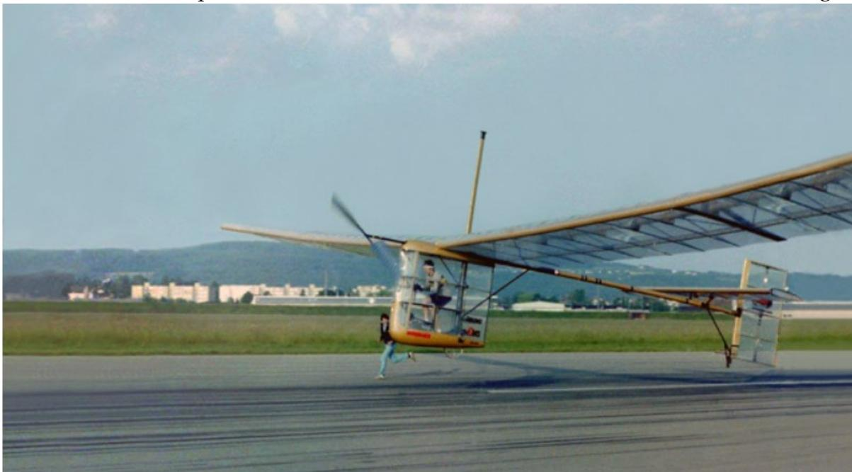
Der Athlet in der Kabine betreibt den Rotor vorn mit Velopedalen – und das Gerät hebt ab und fliegt 800 Meter weit!
